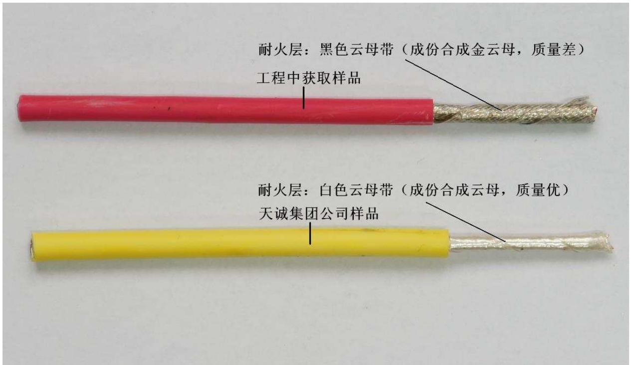
图 1：剥开绝缘后的实拍
