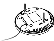
2) 墙上螺钉对准无线红外转发器底壳较大的圆内。
